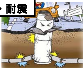
下水道管・マンホールの耐震・液状化対策として、埋め戻し土に固化材や稼働する継手の活用
